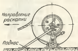
Рис. 48. Установка барабана с проводом на раскаточном станке.
