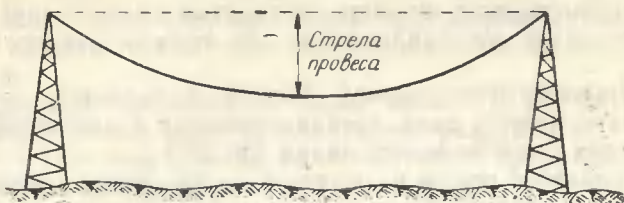
Рис. 3. Стрела провеса провода при одинаковых высотах подвеса.
